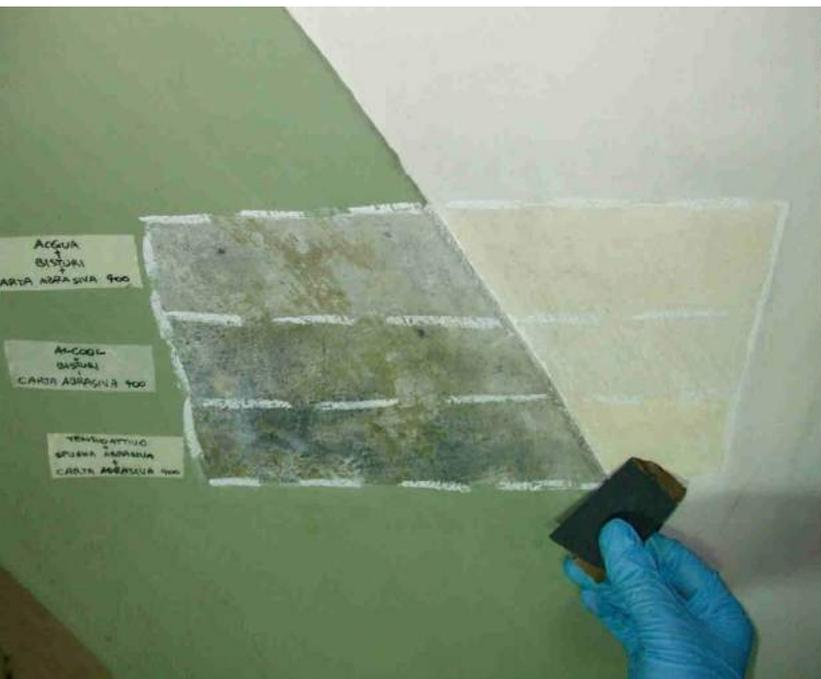
Fig. 25 Test di pulitura della volta.
