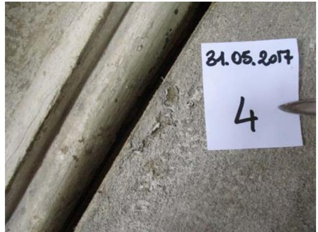
Dettaglio del punto di prelievo del campione CGV-4
