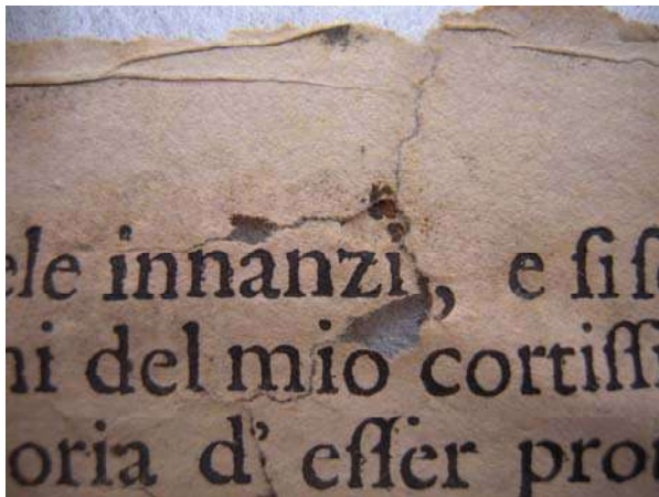
Figura 34: lacerazione ed infeltrimento dovuto ad un attacco fungino
