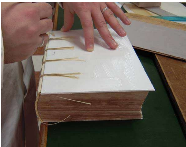
Figura 80: incollaggio dei nervi sfilacciati sul primo cartone
