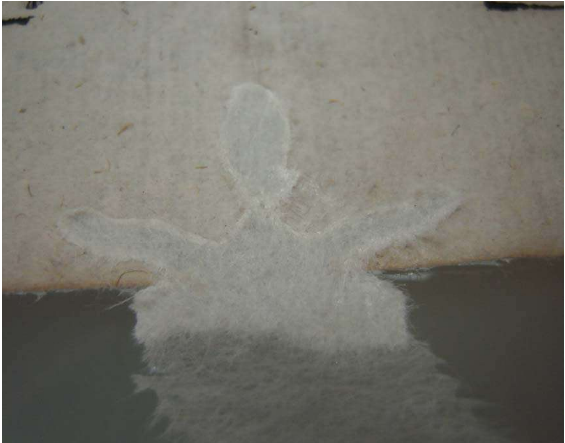
Figura 66: scarnitura completa con la presenza della corona perimetrale costituita dalle fibre della carta sfilacciata
