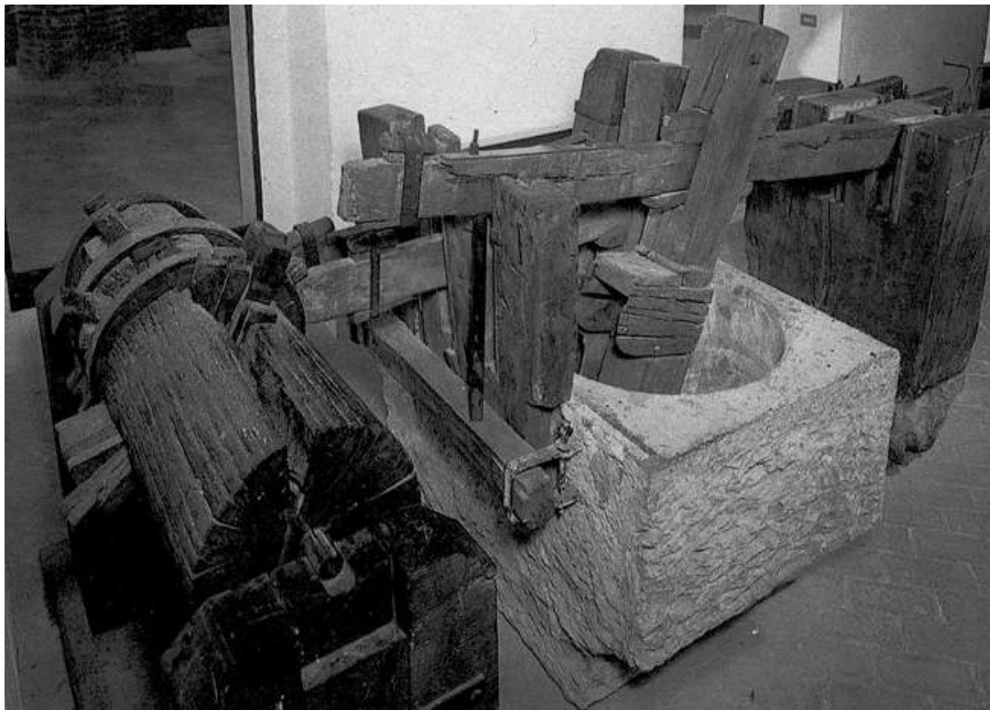
Figura 12: pila idraulica a magli multipli (sec. XVIII), Museo della Carta e della Filigrana di Fabriano
