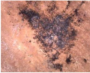
(Foto1.1: I funghi cromogeni di superficie, fotografati con il microscopio “Dinolite”, a luce normale, ingrandimento a 50X.)
