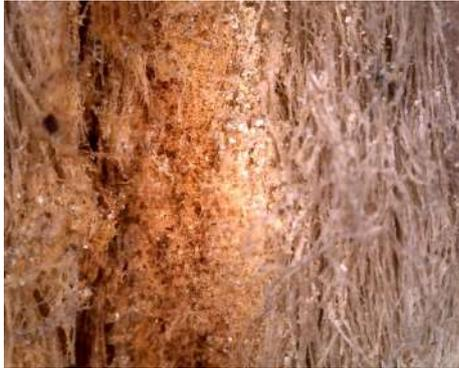
(visione al microscopio “Dinolite” del legno attaccato da fungo cariogeno, ingrandimento 50X, luce normale.)
