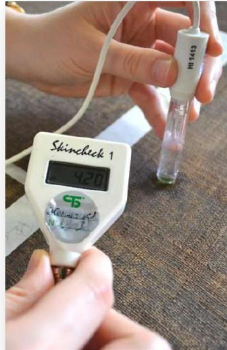
*Figura 51 La misurazione del pH tramite pHmetro a contatto*
