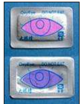
93. Cambiamento di colore degli Oxy Eye in seguito all'eliminazione di ossigeno
