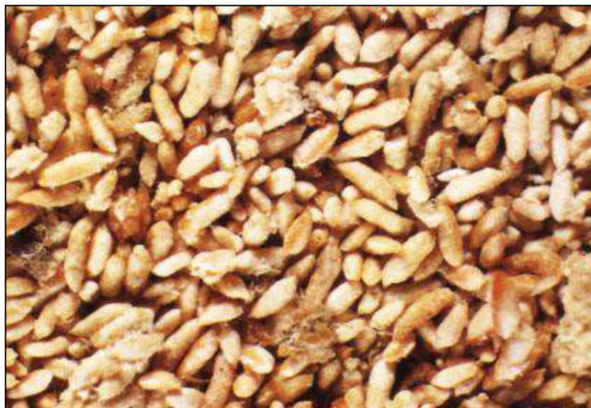
78. Foto a 200 ingrandimenti del rosime di Anobium Punctatum
