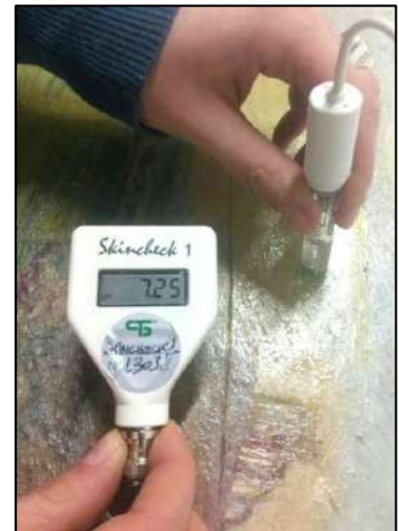
112. Misurazione del Ph
