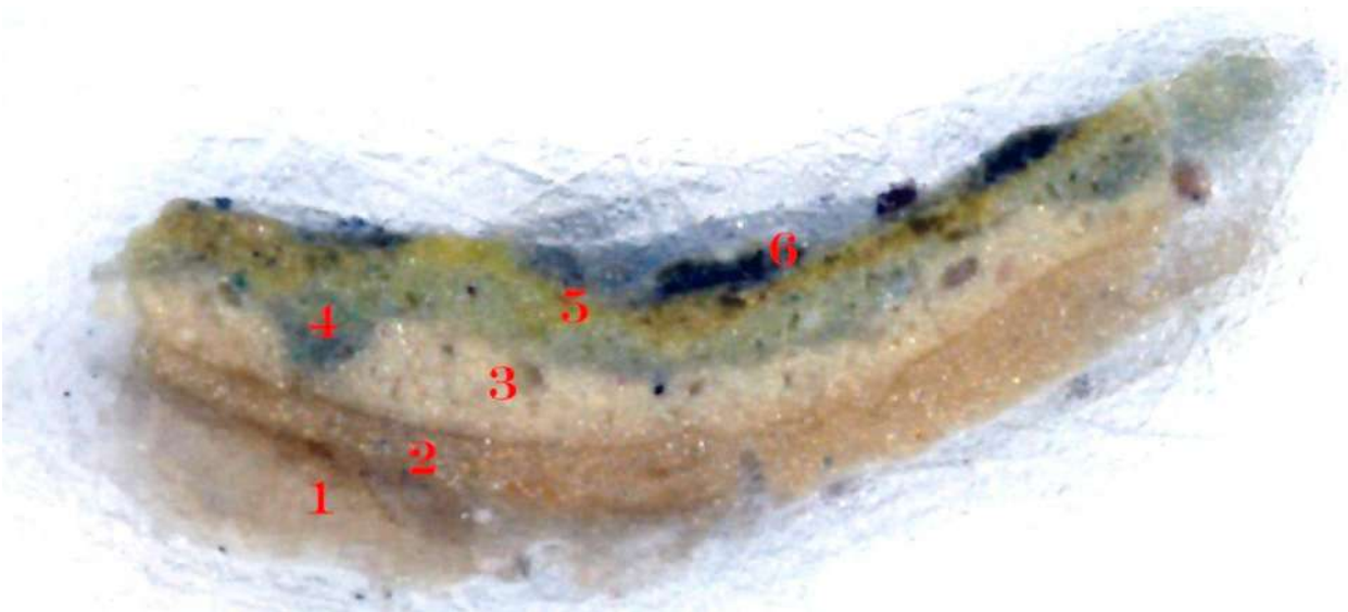
71. Sezione stratigrafica del campione B in luce riflessa (200x)
