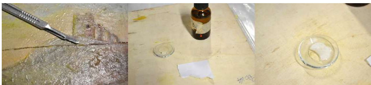
77. Punto di prelievo, addizione dei reagenti e formazione di abbondante schiuma
