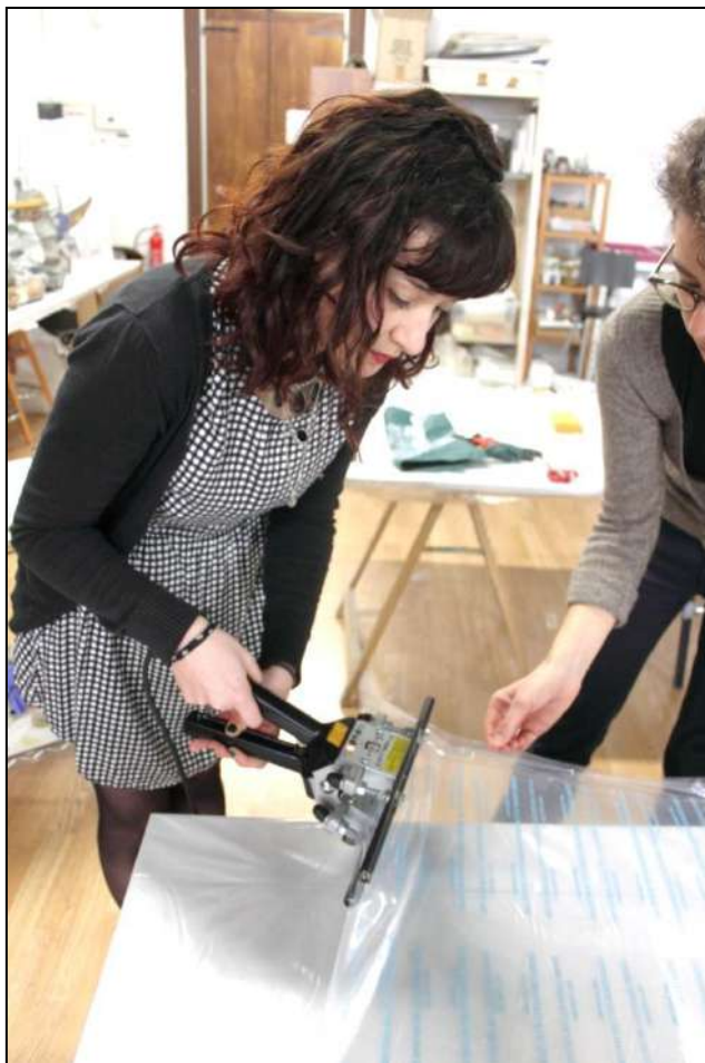
87, 88, 89. Varie fasi della termosaldatura del sacco
