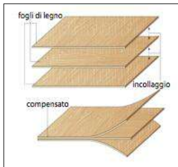
20. Incollaggio dei vari strati del pannello
