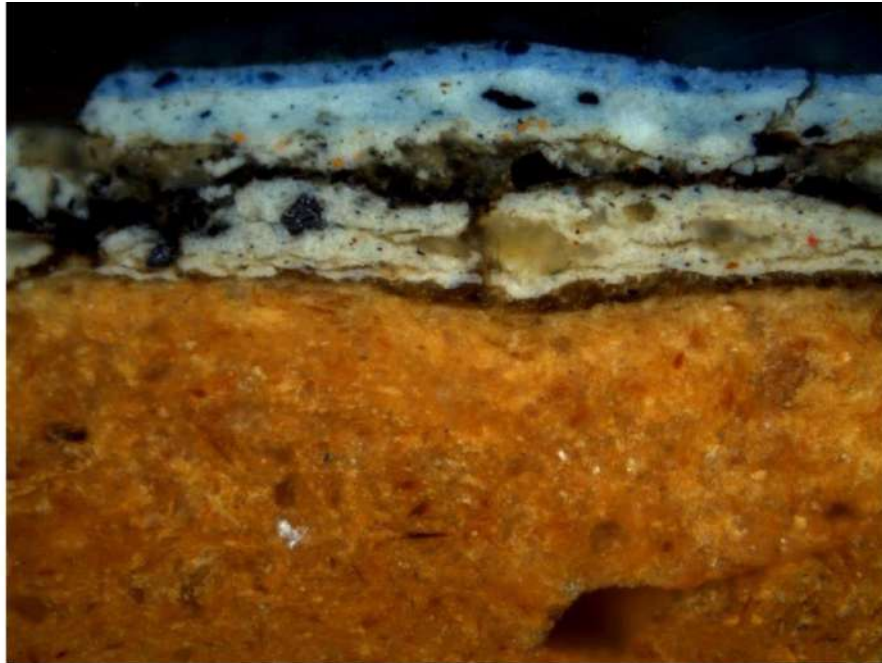
Sezione stratigrafica in luce visibile riflessa, campo scuro, obiettivo 200X, particolare sx-c
