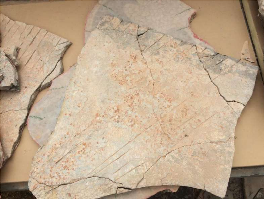
Figura 54. Una sezione levigata. Si nota il sottile strato di cocchiopesto e lo strato finale di malta cementizia con la graniglia.
