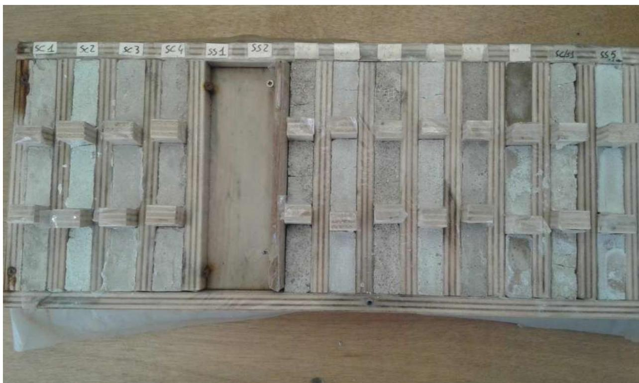
Figura 19 Campionario completo dopo il ciclo di invecchiamento, nella parte destra si nota l'efflorescenza
