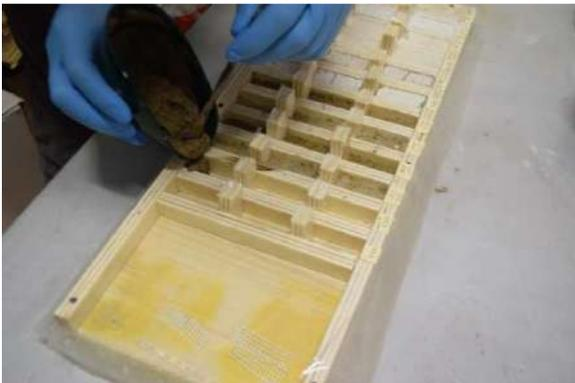
Figura 17 Preparazione del primo strato dei campioni a base silicatica, con inserimento di retina in fibra di vetro
