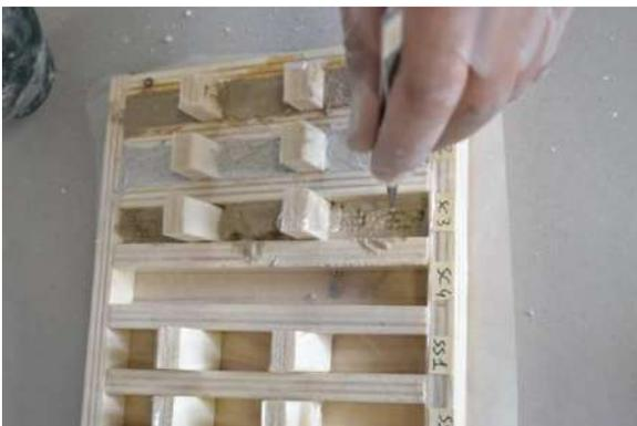
Figura 16 Preparazione dei campioni a base di calce, in unica volta, con inserimento di retina in fibra di vetro
