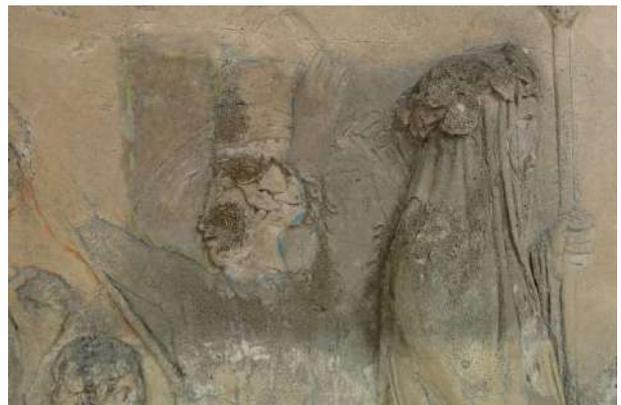
*Figura 30: Applicazione e rimozione della prova con Vinavil su menade*
