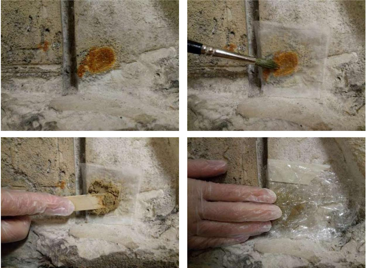
*Figura 37: Prova di estrazione dei pigmenti, applicazione della sepiolite*
