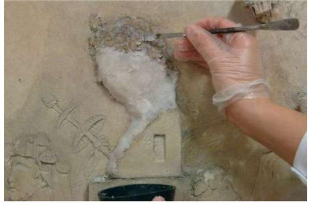
*Figura 29 Applicazione e rimozione della prova di Nevek e acetone sul busto di Bacco*
