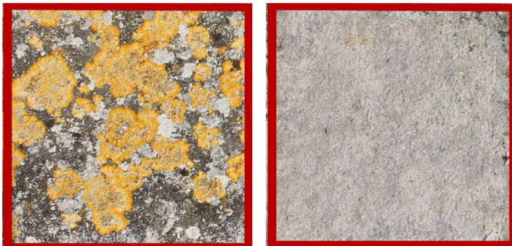
Fig.16 **Tassello D** (*Caloplaca sp.* prima e dopo 2 applicazioni di Nasier Lapideo L01.a® da 30 minuti ciascuna con copertura di PVC)
