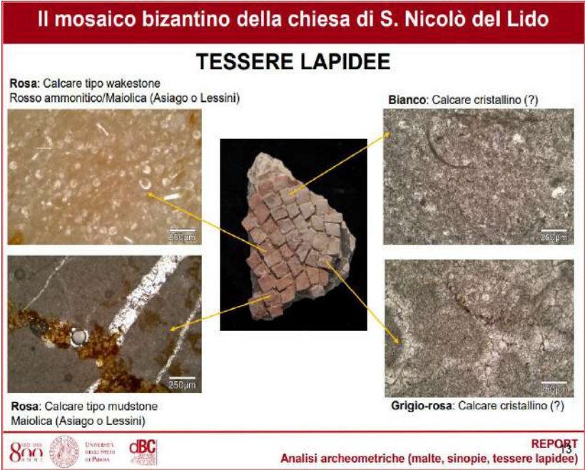
Figura 22. Risultati delle analisi: le tessere lapidee.
