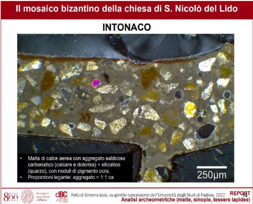
Figura 23. Risultati delle analisi: l'intonaco.
