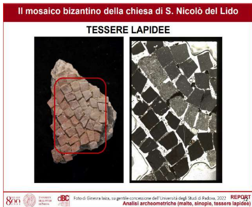
Figura 21. Risultati delle analisi: le tessere lapidee.
