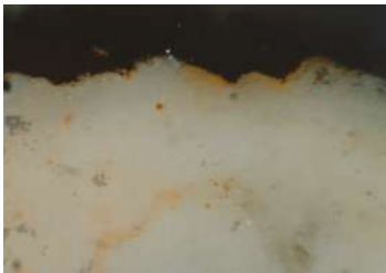
Fig. 2.8. Campione analizzato di crosta nera e ossidi di ferro dispersi su Pietra d'Istria. (L.R. ingr. 183 X).
