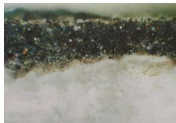
Fig. 2.6. Campione analizzato raffigurante una crosta nera di notevole spessore su marmo. (L.R. ingr. 108 X).
