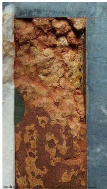
Fig 3.10 a. Immagine della lastra in Marmo Rosso Verona in evidente stato avanzato di degrado.
