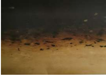
Fig. 2.7 a. Campione analizzato che figura una crosta nera su pietra con patina di ossalato di calcio (L.R. ingr. 183 X).
