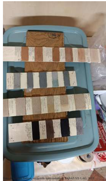
Fig 3.5. Prime prove di impasti per le stuccature stese su tavelle in legno.
