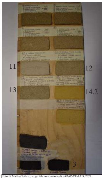
Fig 3.9. Tavella con maltine finali per le varietà di colore giallo, nero e neutro.
