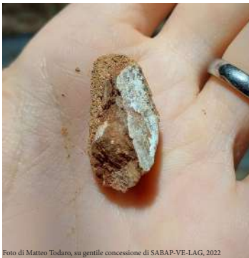
Fig 3.3. Strato di cristallizzazione dei Sali in un lato del frammento in marmo.
