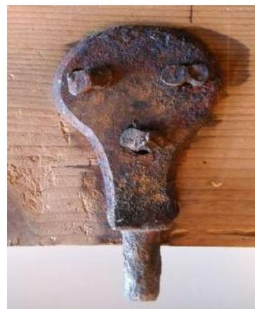
*Fig. 30: Elemento metallico per l'ancoraggio a terra visibilmente ossidato*
