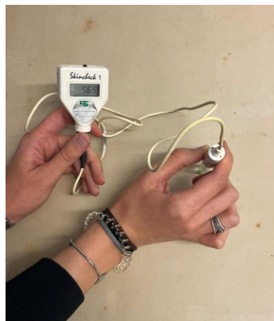
Figura 32: Misurazione del pH sul verso
