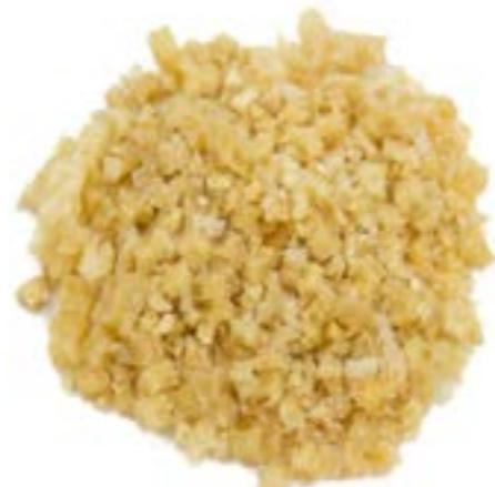
Fig. 25: colla di coniglio in granuli.
