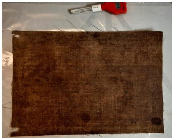
**Figura 15** - Misurazione del PH con Phmetro.
