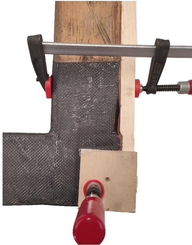
Figura 26 Dettaglio dell'aggiunta di un listello alla traversa di base del telaio ....
