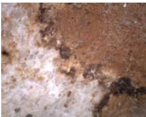
Fig.6 Porzione di ossalato di calcio visibile attraverso microscopio elettronico
