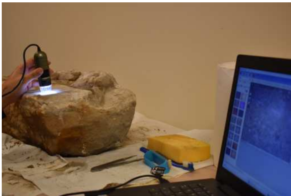
Fig.5 analisi non invasive con microscopio elettronico “Dinolite”.
