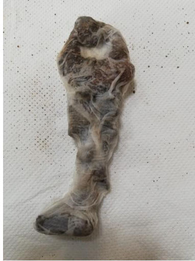
Foto 13-14-15.13: Pulitura umida con chelante EDTA bisodico e tetrasodico a mezzo specillo in cotone; 14-15. Impacco per i reperti in ferro e bronzo con EDTA bisodico e tetrasodico a mezzo carta assorbente da casa. Fotografie di M.
