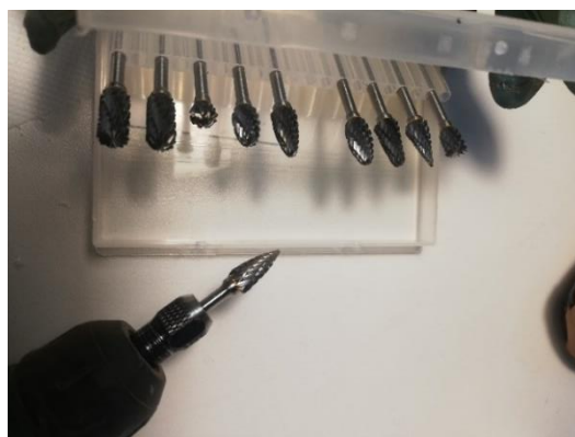
Foto 6-7.6: “Kit del restauratore” con strumenti e sostanze utilizzati per il restauro; 7: Diverse punte utilizzate in base alla durezza dell’ossidazione da ridurre sui chiodi in ferro.
