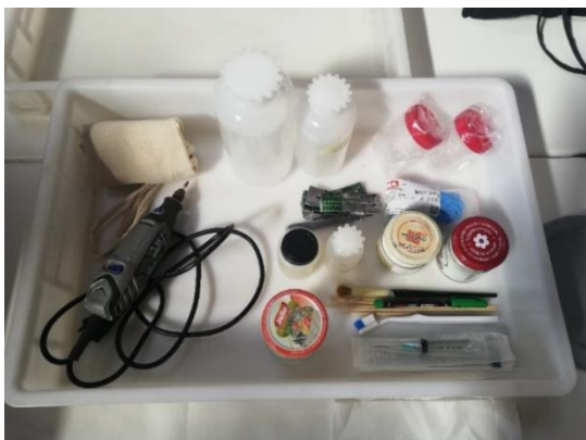
Foto 6-7.6: “Kit del restauratore” con strumenti e sostanze utilizzati per il restauro; 7: Diverse punte utilizzate in base alla durezza dell’ossidazione da ridurre sui chiodi in ferro.
