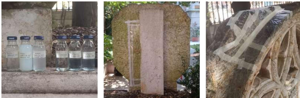
Fig. 3: Realizzazione tesselli prova con diverse formulazioni
