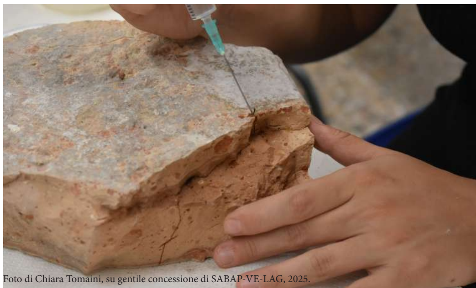
(Fig. 6) Iniezioni di Paraloid B72 nelle lesioni passanti.
