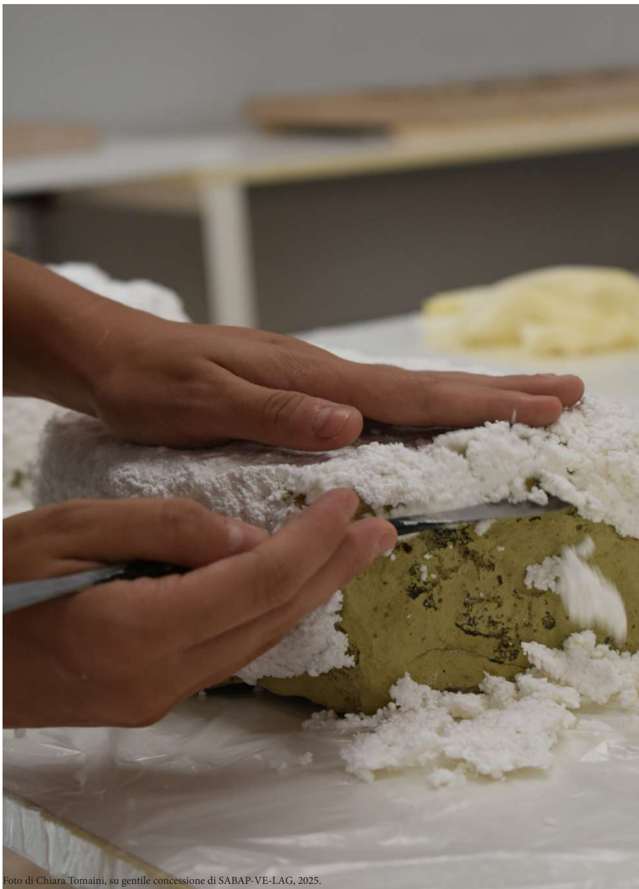
(Fig. 5) Rimozione dell'impacco desalinizzante.
