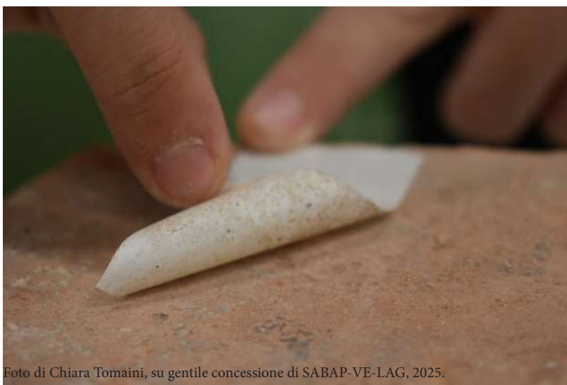
(Fig. 8) Tape test su laterizio a cromia rossa (gruppo A).
