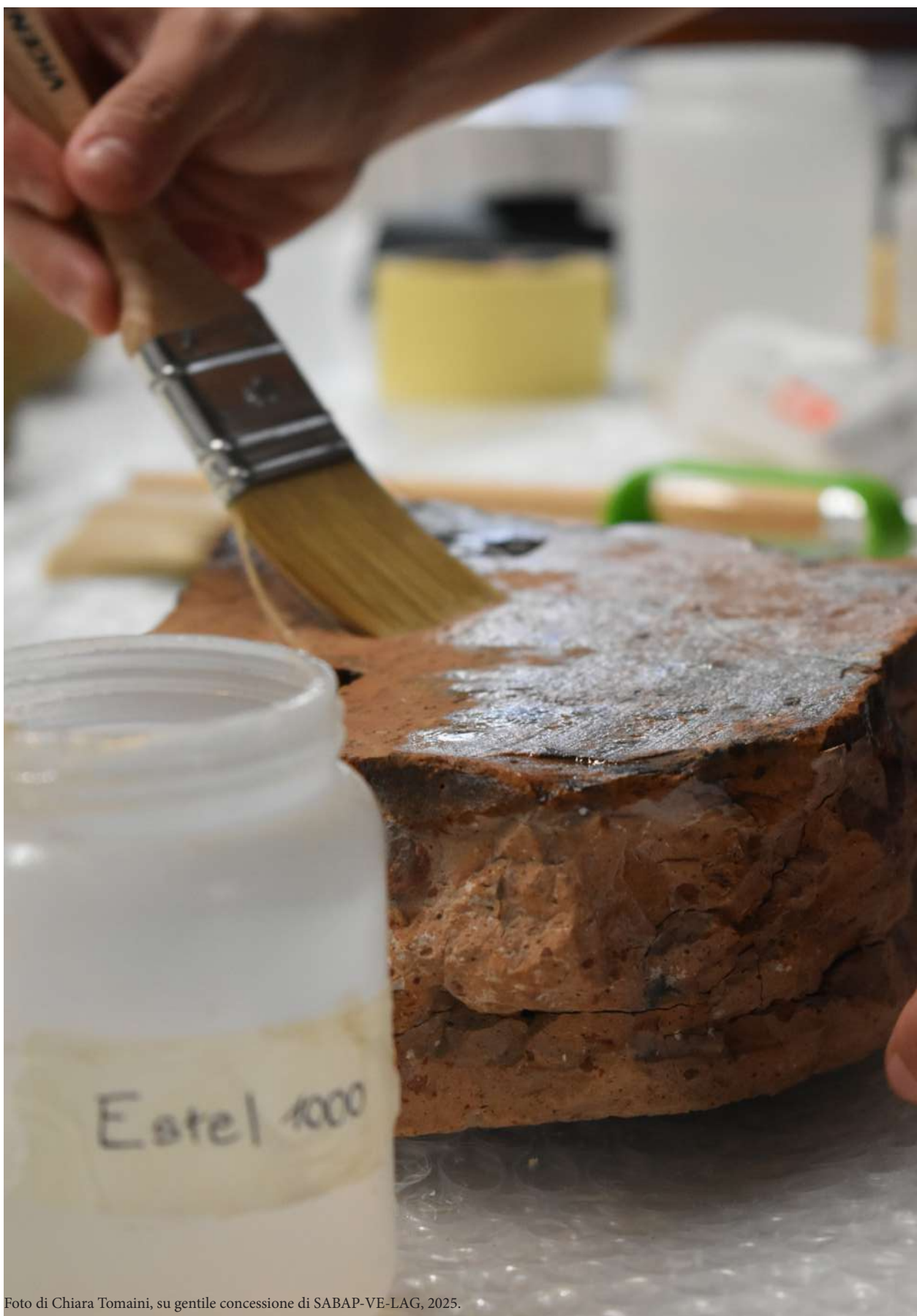
(Fig.7) Applicazione a pennello di Estel 1000.
