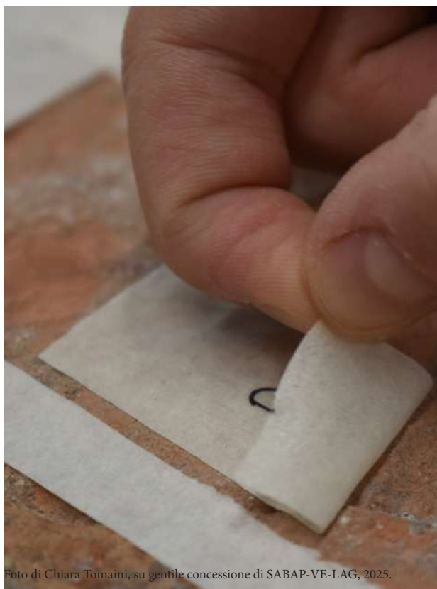
(Fig. 12) Tape test dopo il consolidamento con Estel 1000.
