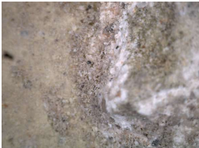
(Fig. 1) Residui di malta di allettamento presenti sulla superficie. (Osservazione al microscopio digitale Dino-Lite).
