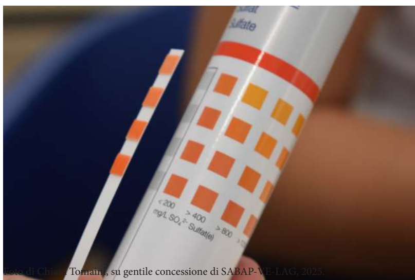
(Fig. 5) Risultato test con cartina reattiva per solfati ( \text{SO}_4^{2-} ).
