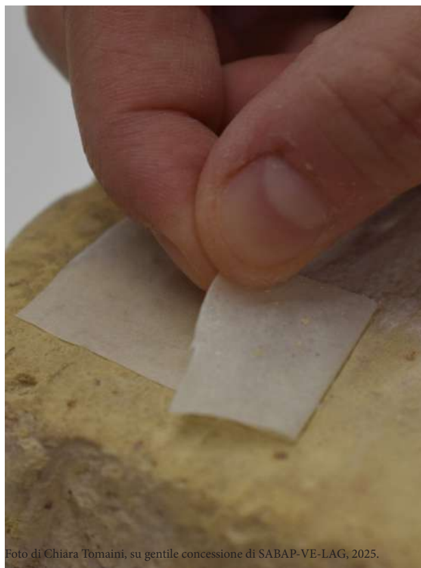
(Fig. 13) Tape test dopo il consolidamento con Estel 1000.
