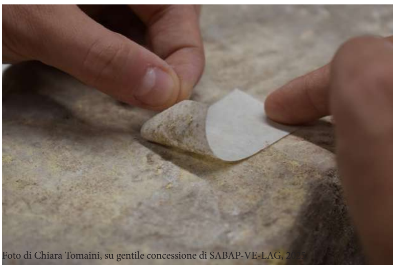
(Fig. 7) Tape test su laterizio a cromia gialla (gruppo B).
